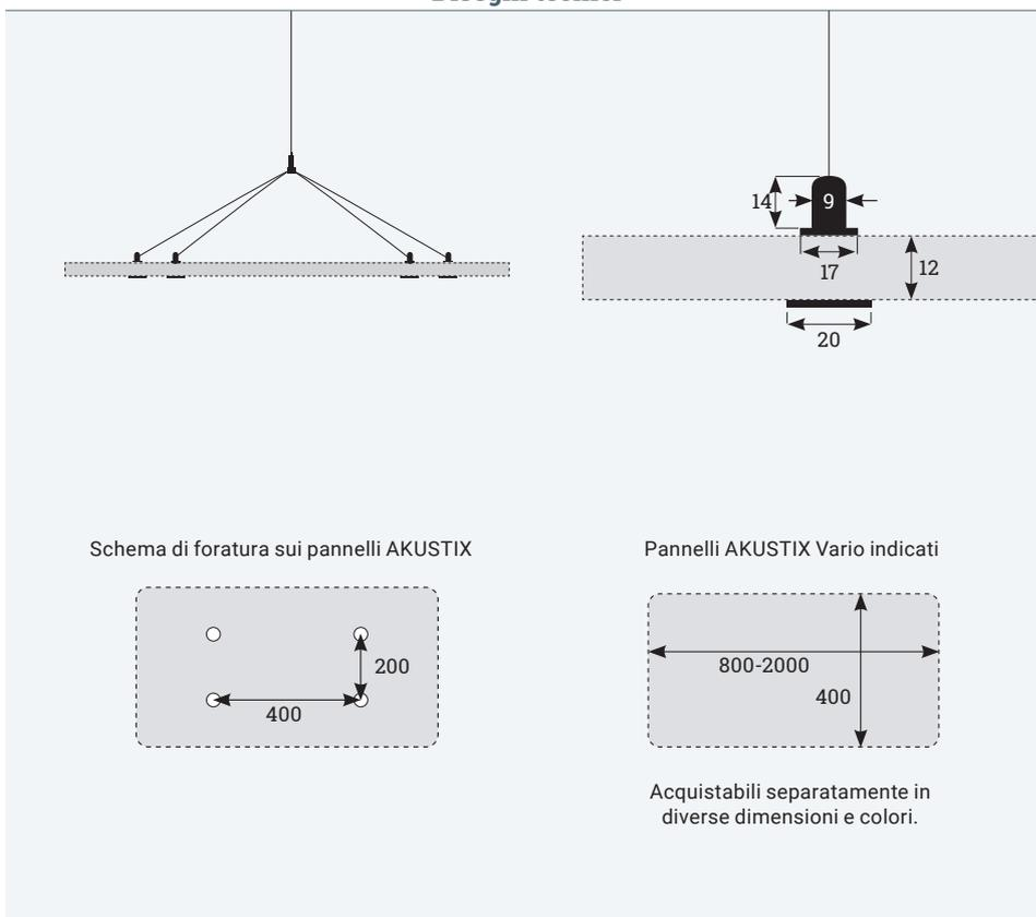
I pannelli AKUSTIX mostrati nelle immagini non sono inclusi. Il numero di set di fissaggio raccomandati varia in base all'ampiezza dei pannelli AKUSTIX Vario utilizzati. Si raccomanda un fissaggio ogni 600 mm di pannello.
