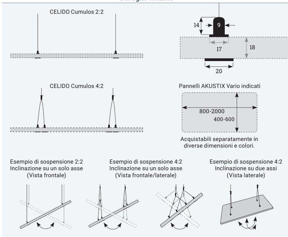
I pannelli AKUSTIX mostrati nelle immagini non sono inclusi. Il numero di set di fissaggio raccomandati varia in base all'ampiezza dei pannelli AKUSTIX Vario utilizzati. Si raccomanda un fissaggio ogni 600 mm di pannello.
