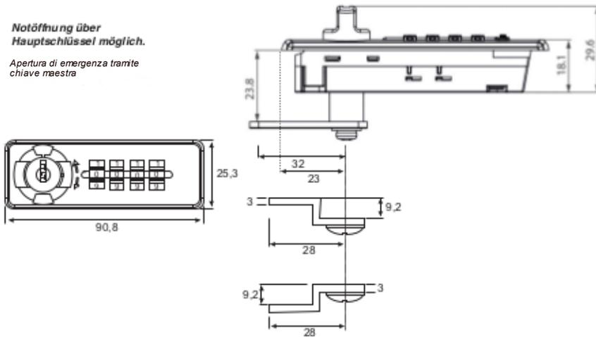
Bohrbild für Holz / Schema di foratura per ante in legno
